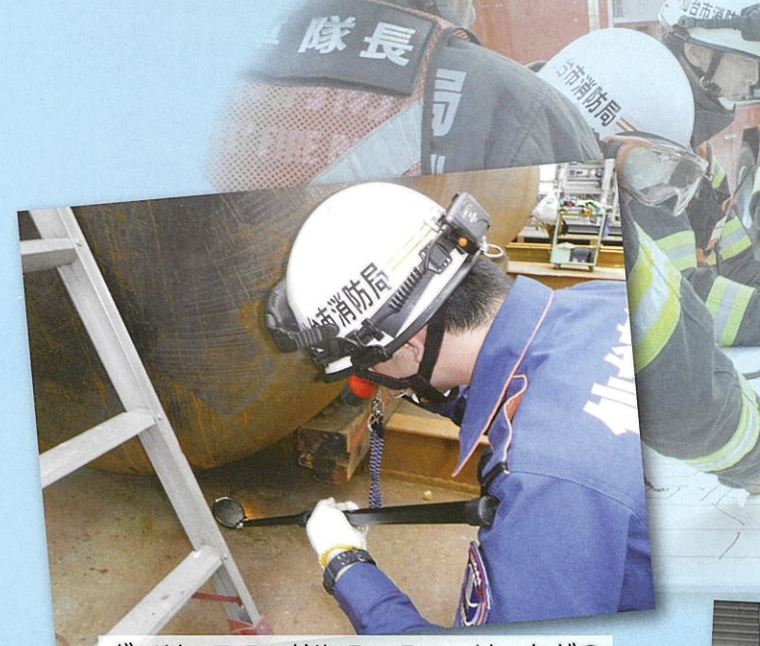
ガソリンスタンドやタンクローリーなどの危険物・高圧ガス施設が安全かどうかをチェックしています。
